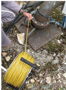
Mesure du niveau d'eau dans un forage agricole
